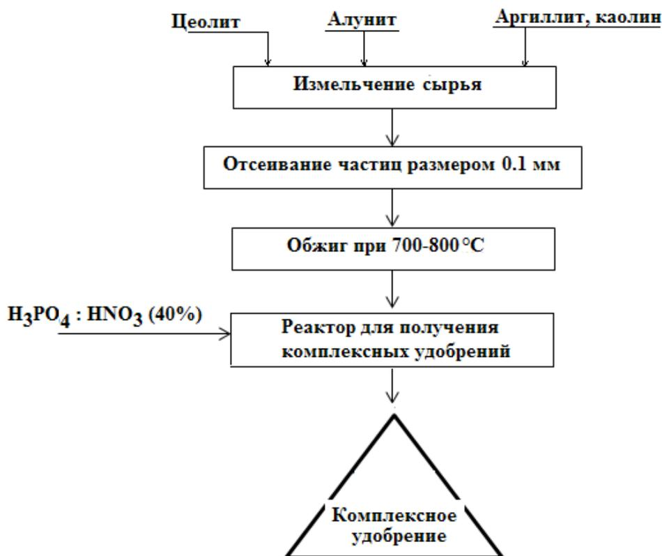
**Рисунок 1 – Технологическая схема получения комплексных удобрений, содержащих калий, азот и фосфор.**
