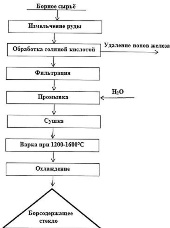
Рисунок 1 - Технологическая схема получения боросиликатного стекла.
