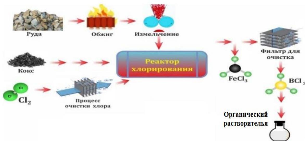
**Рисунок 3** - Установка для хлорирования данбурита и датолита.
